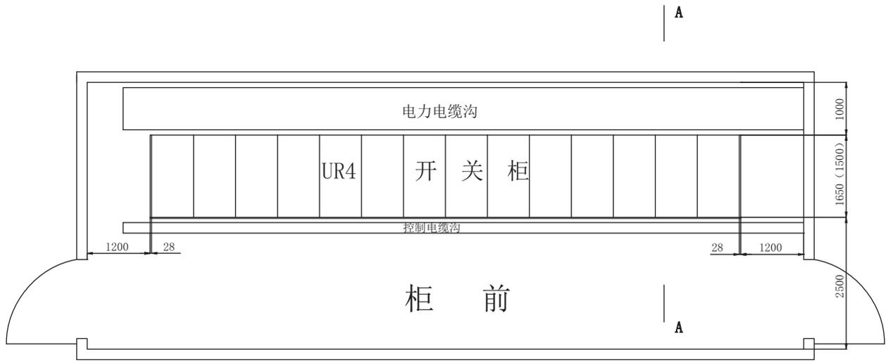
图 12: 配电室典型平面布置图——后维护
